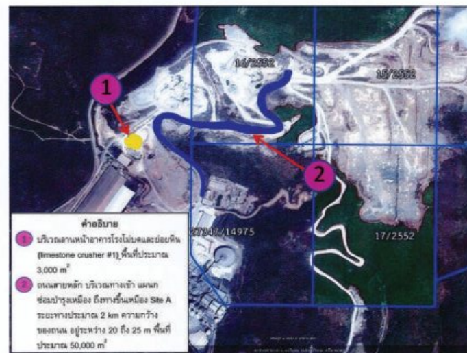
รูปที่ 2: พื้นที่ดำเนินการปรับปรุงจากดินลูกรัง เป็นคอนกรีตเสริมเหล็ก ปี พ.ศ. 2556-2558
